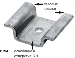
Скрытый пазовый крепеж Омега-А (Омега ОАЦ) предназначен для монтажа террасной профилированной пазовой доски с асимметричным пазом; в зависимости от параметров нижней полки паза доски обеспечивает технологический зазор 3-18 мм.
