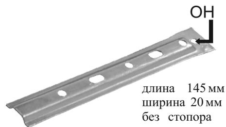
Скрытый металлический крепеж Змейка-Лодочка длиной 145 мм без стопора предназначена для монтажа террасной и фасадной доски со скошенным или прямым профилем шириной от 70 до 110 мм, а также для облицовки внутренних стен, потолков; без ограничения технологического зазора.
